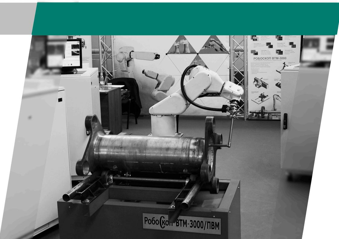
Робоскоп ВТМ-5000/ПВ-М (далее Робоскоп ВТМ-5000/ПВ) - автоматизированная система неразрушающего контроля полого вала, для колесных пар вагонов серии 81-720, 81-721, 81-740, 81-741 Московского метрополитена.
