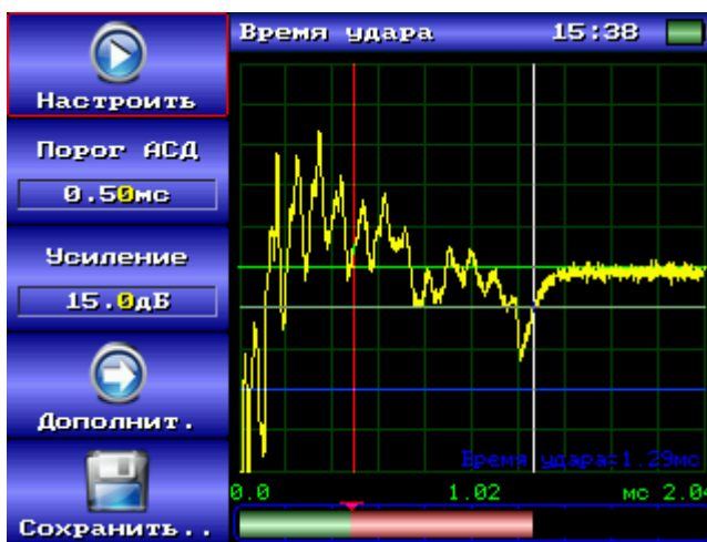
Рисунок D. 8 Ударные колебания на дефектном участке меры дефектов TS-2.
