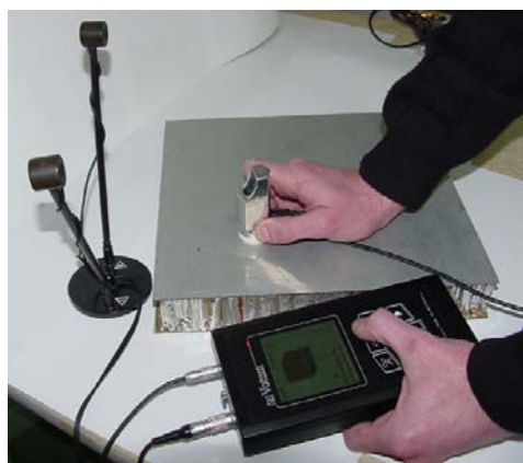
Рис. 1. Процесс контроля с помощью дефектоскопа ДАМИ-С
