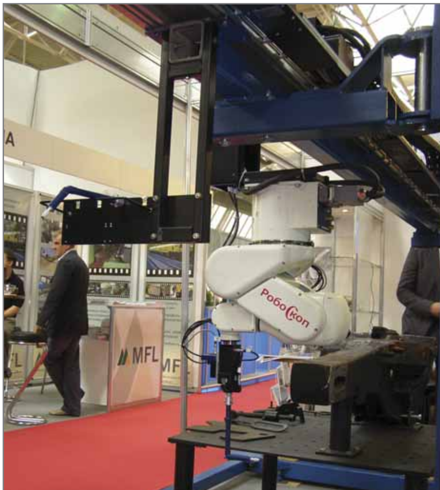
«Робоскоп 3000»- роботизированный комплекс неразрушающего контроля и лазерного обмера геометрических параметров
